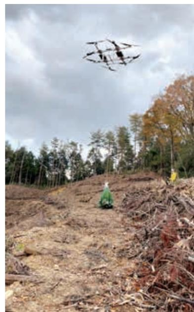
1回に約30kg(約150本)の苗木を現場へ運ぶ大型ドローン
